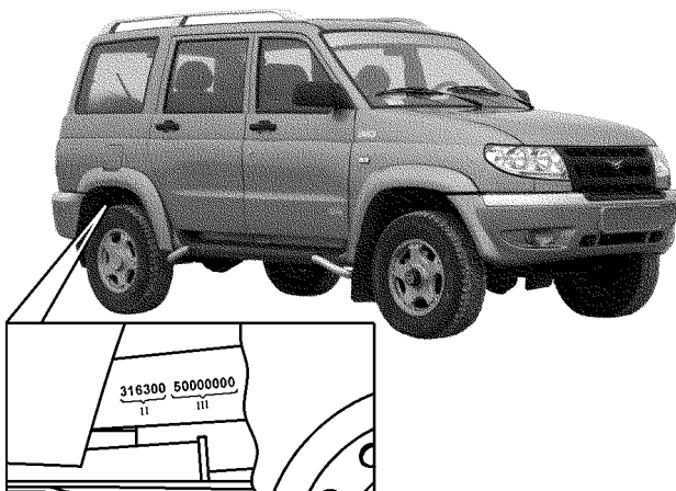
Рис. 1.3. Расположение идентификационного номера шасси
