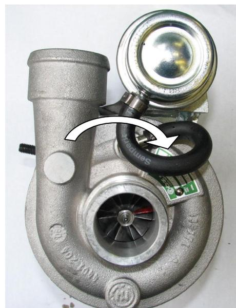
16. Повернуть корпус компрессора (по стрелке) до появления доступа к гайке 8 (см. операцию 12). Отвернуть гайку 8 и снять выпускной коллектор в сборе с ТКР (ключ на «13»). Снять детали присоединенные к ТКР.
