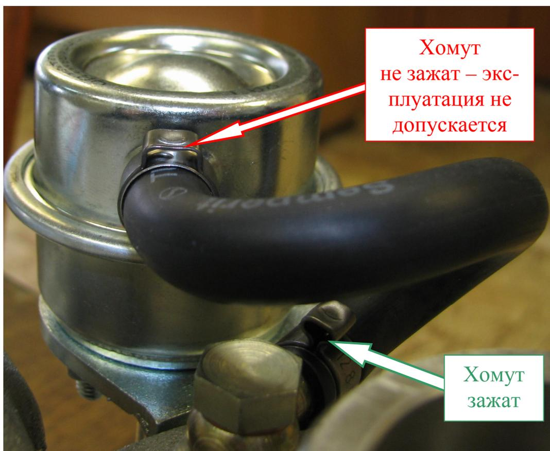
*Рис. 13. Крепление трубки пневмокамеры механизма регулирования.*
