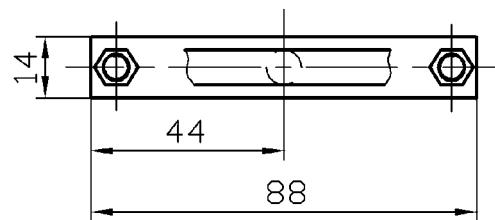
Рисунок А.3 – Приспособление для фиксации распределительных валов
