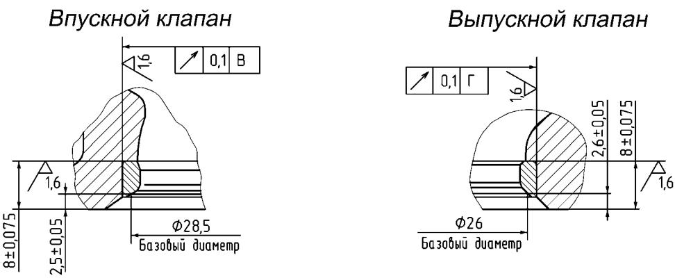
Рисунок 46 – Обработка для запрессовки ремонтных седел
