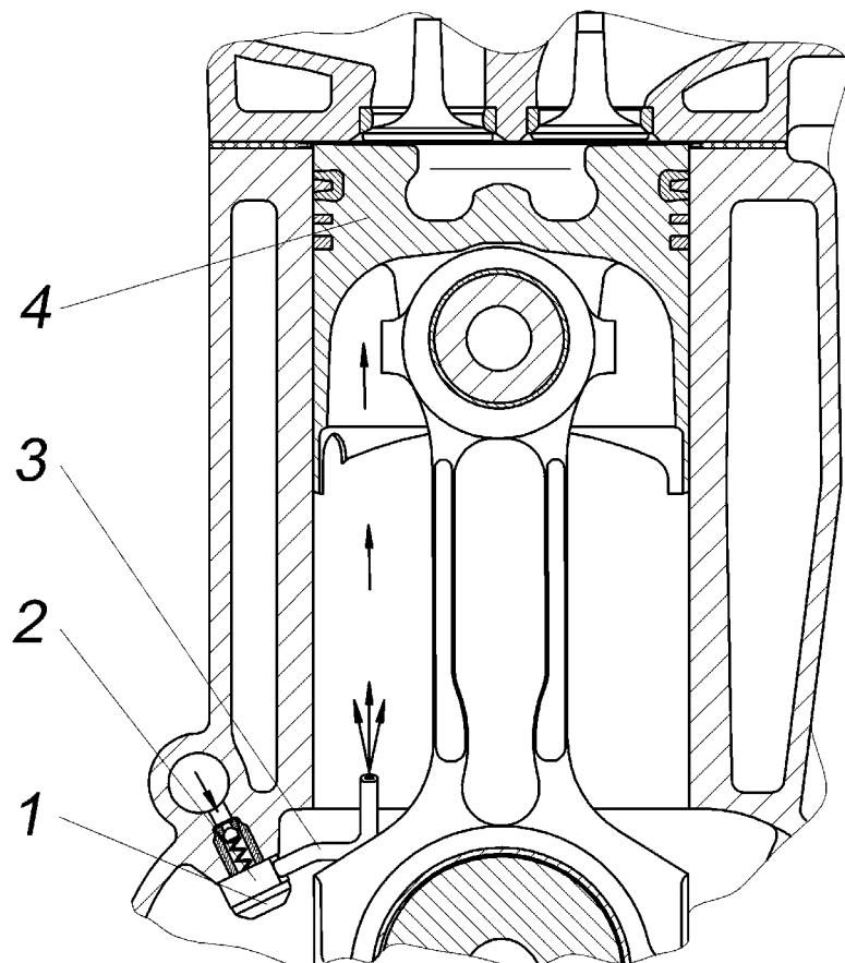
Рисунок 18 – Схема работы форсунки охлаждения поршня:
