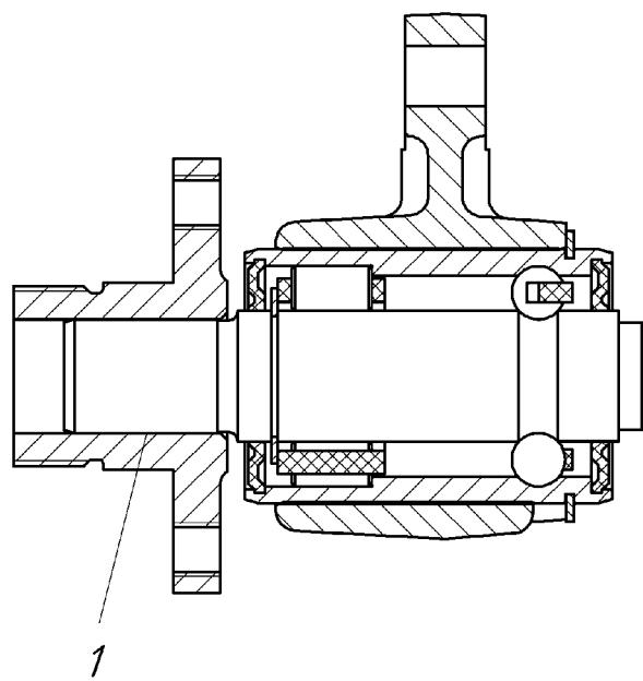
Рисунок В.8 – Привод вентилятора
