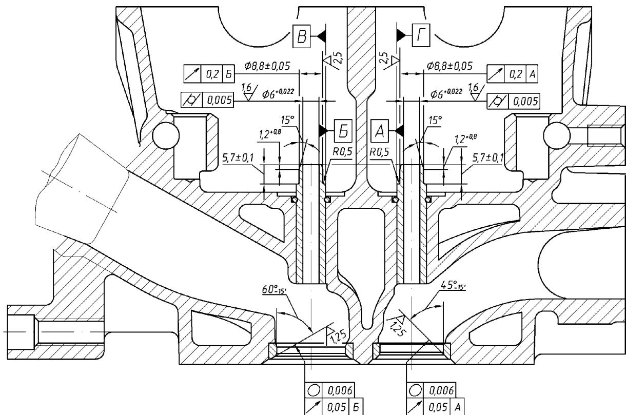
Рисунок 45 – Размеры седел и втулок клапанов
