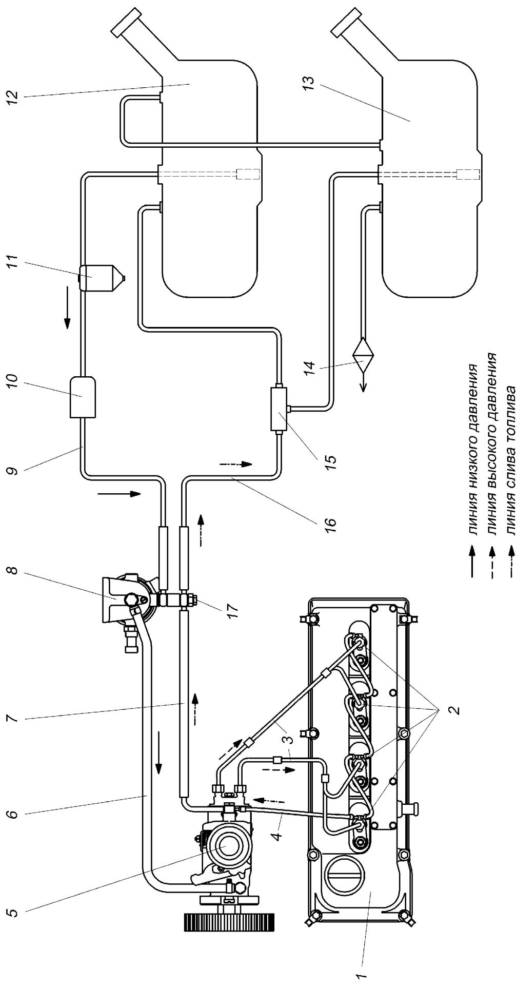
Рисунок 27 – Схема системы питания дизельного двигателя ЗМЗ-5143.10 на автомобиле УАЗ с электрическим топливным насосом:
