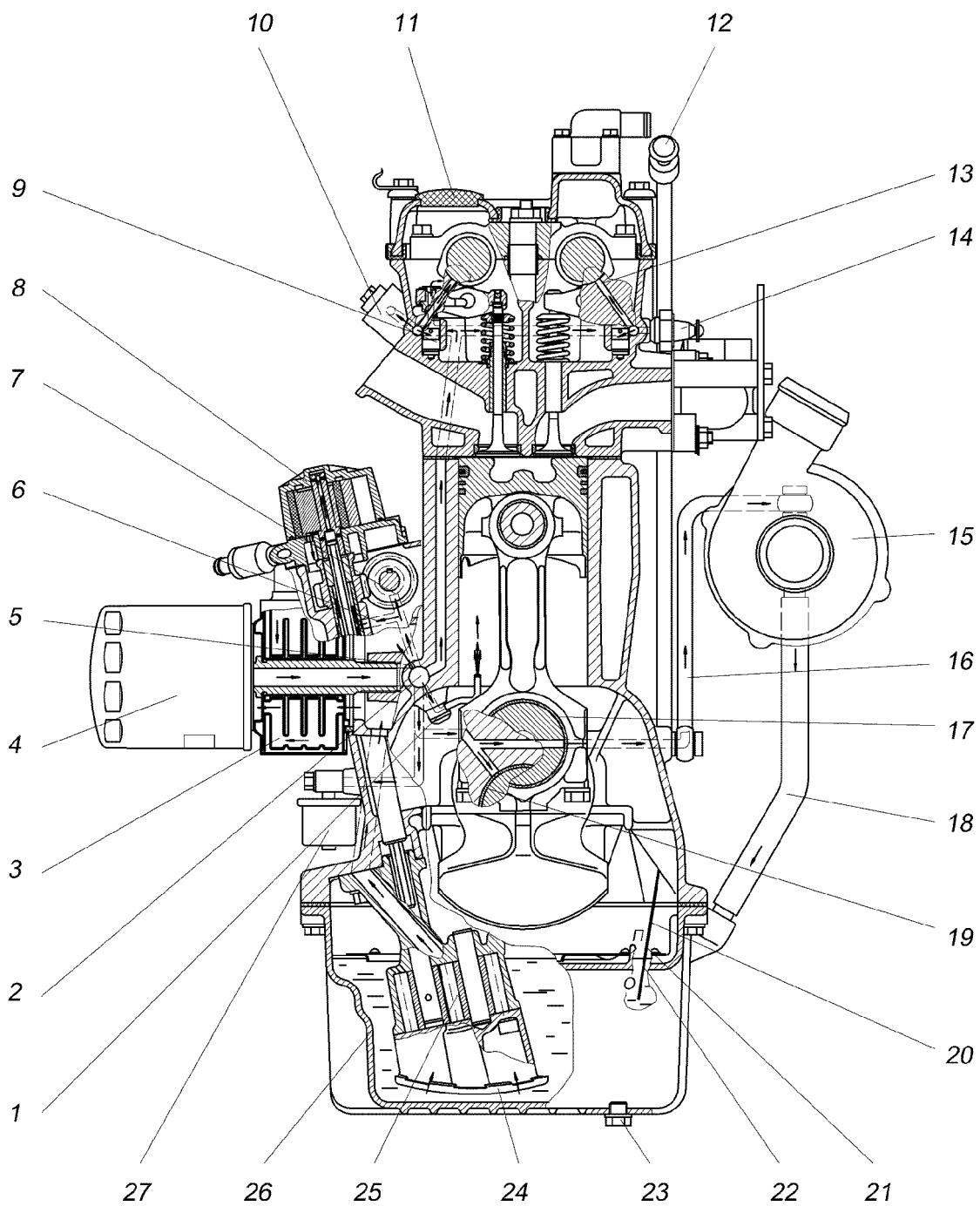
Рисунок 17 – Схема системы смазки:
