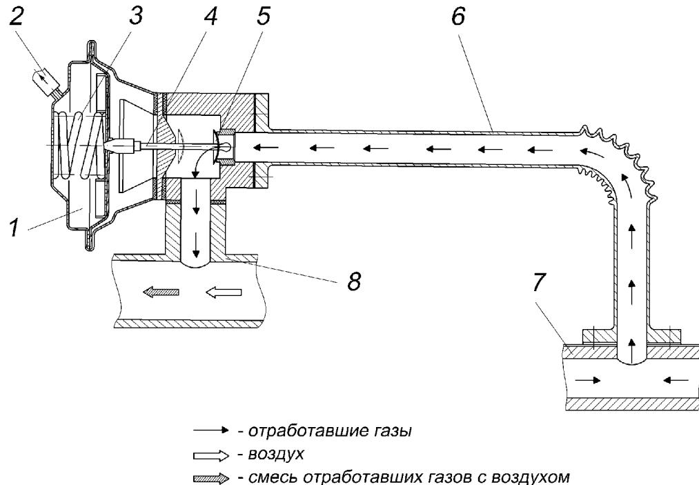
Рисунок 34 – Система рециркуляции отработавших газов:
