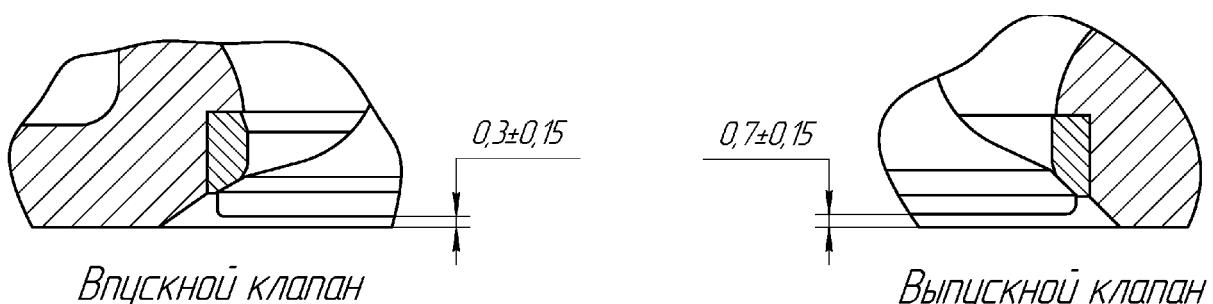
Рисунок 43 – Утопание клапанов
