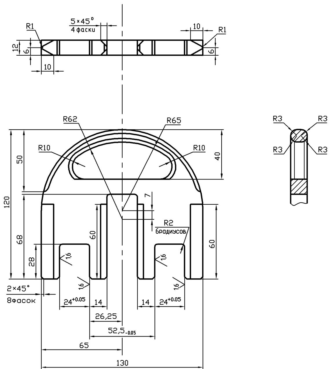
Рисунок А.4 – Приспособление для фиксации распределительных валов ЗМ 7820-4580
