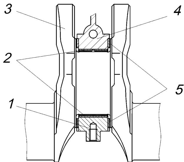
Рисунок 8 – Средний коренной подшипник коленчатого вала:
