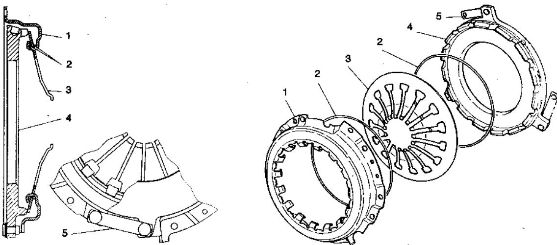
Рисунок 37 – Нажимной диск в сборе и детали нажимного диска:
