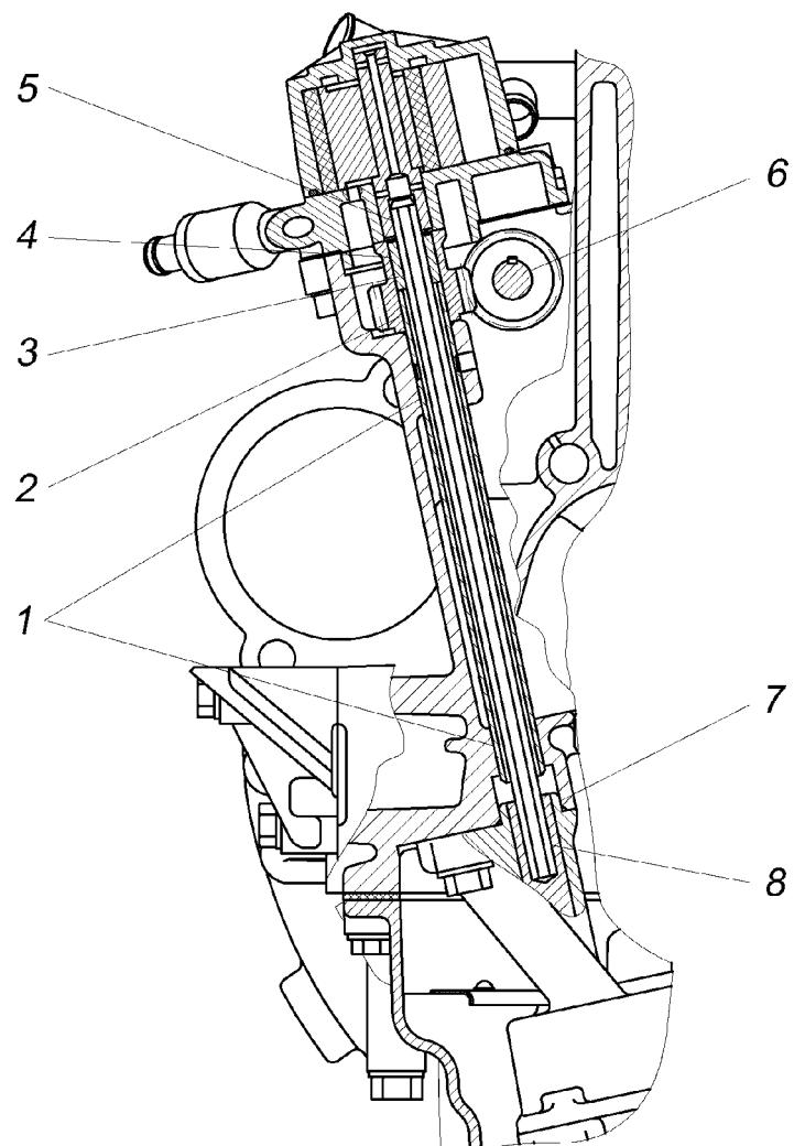
Рисунок В.5 – Привод масляного насоса
