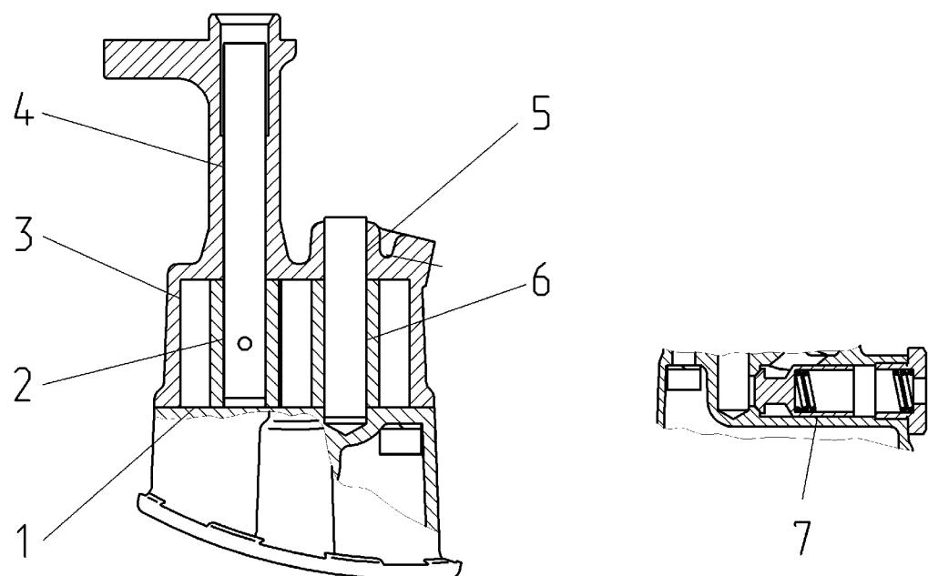
Рисунок В.6 – Масляный насос и редукционный клапан
