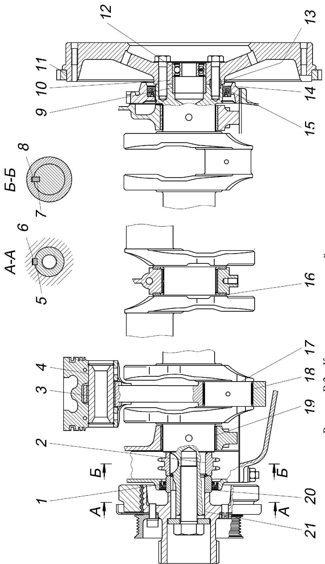
Рисунок В.2 – Кривошипно-шатунный механизм
