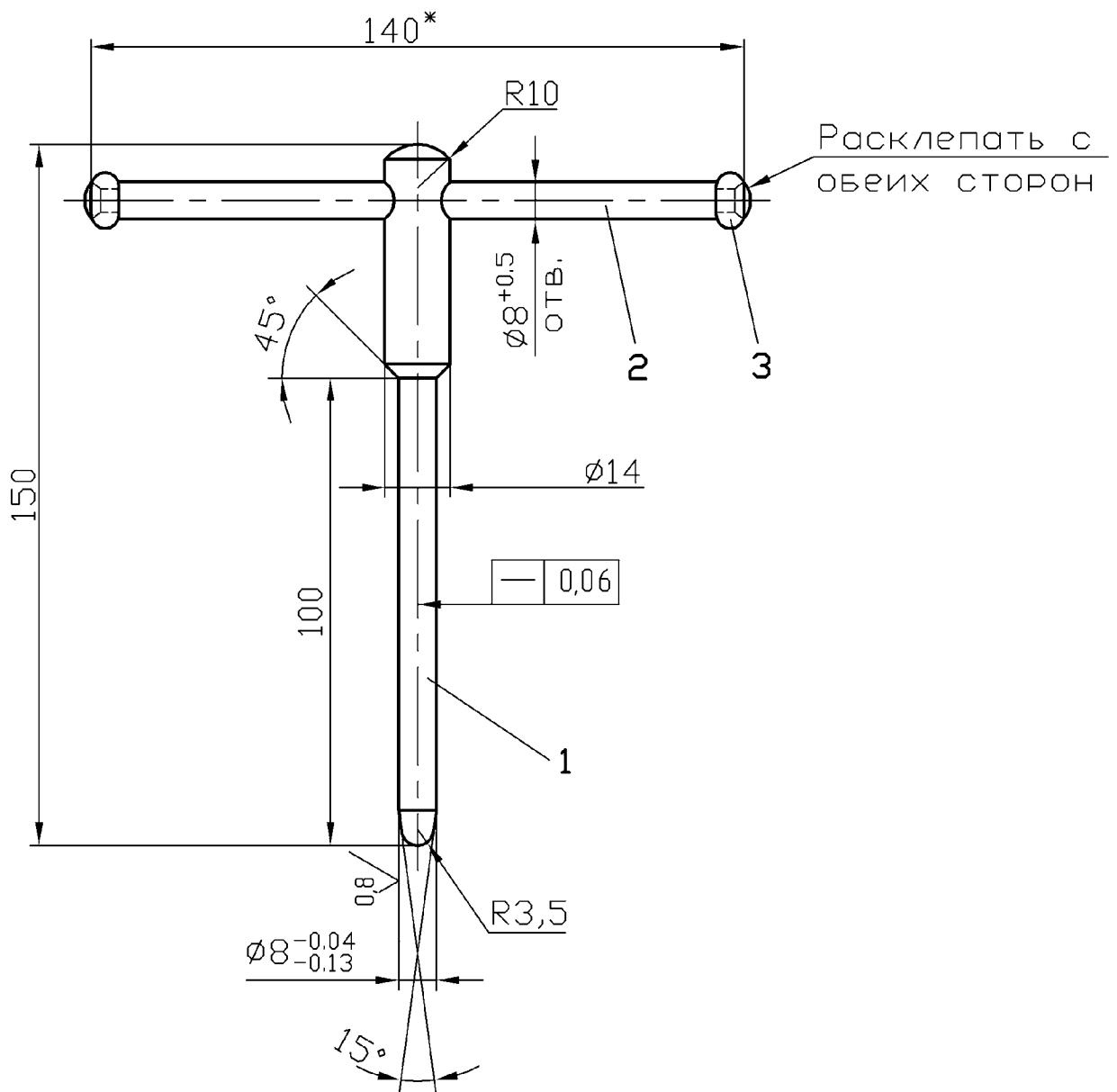
Рисунок А.1 – Штифт установочный коленчатого вала ЗМ 7820-4582:
