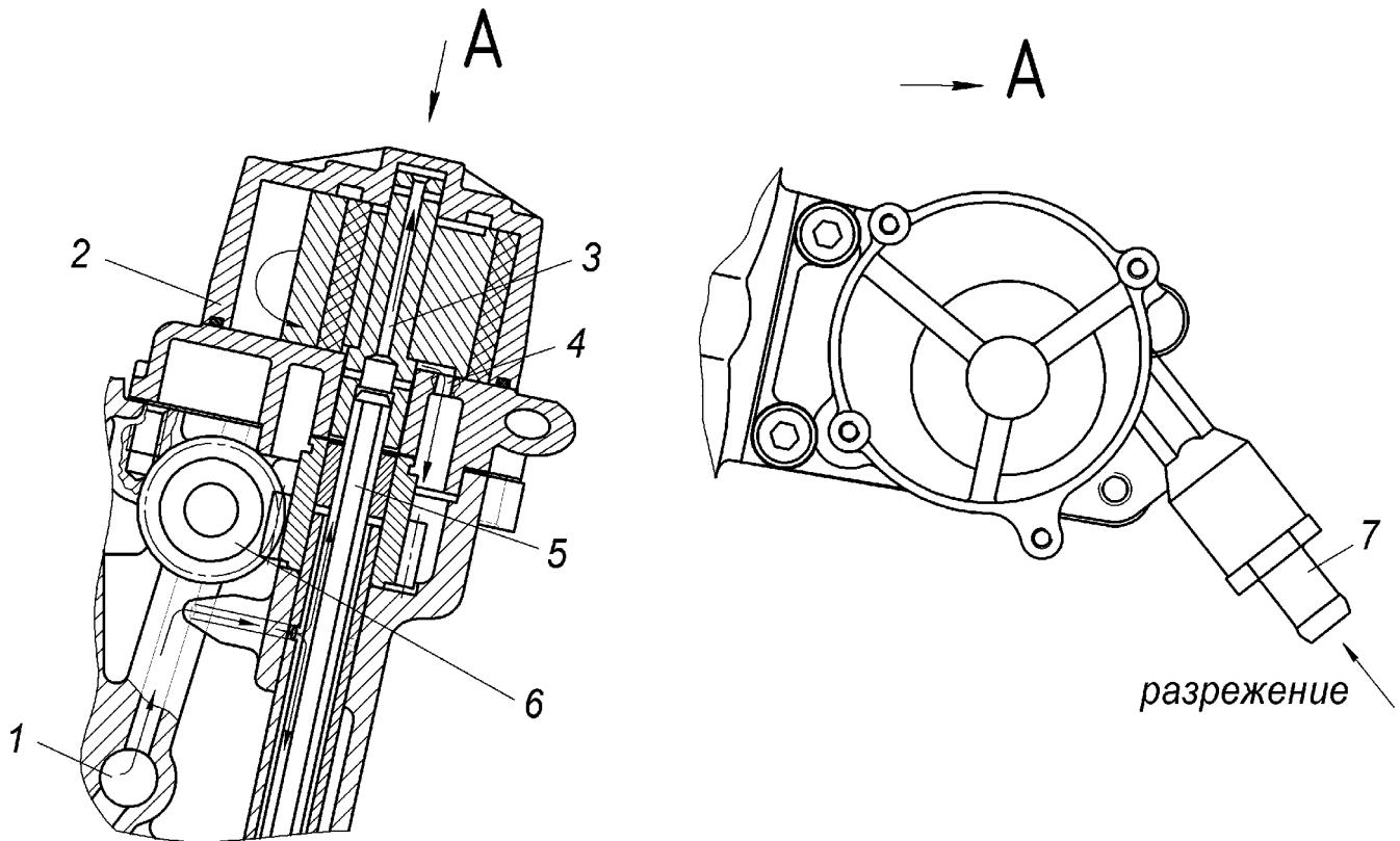
Рисунок 35 – Вакуумный насос:
