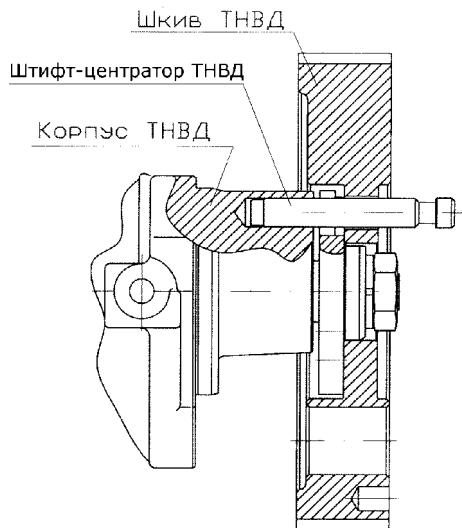
Рисунок 41 – Шкив ТНВД, зафиксированный штифтом
