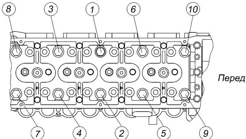
Рисунок 57 – Последовательность затяжки болтов крепления головки цилиндров
