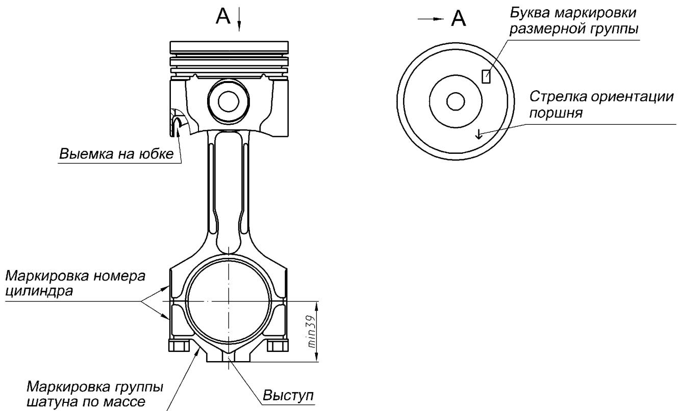
Рисунок 56 – Маркировка поршня и шатуна
