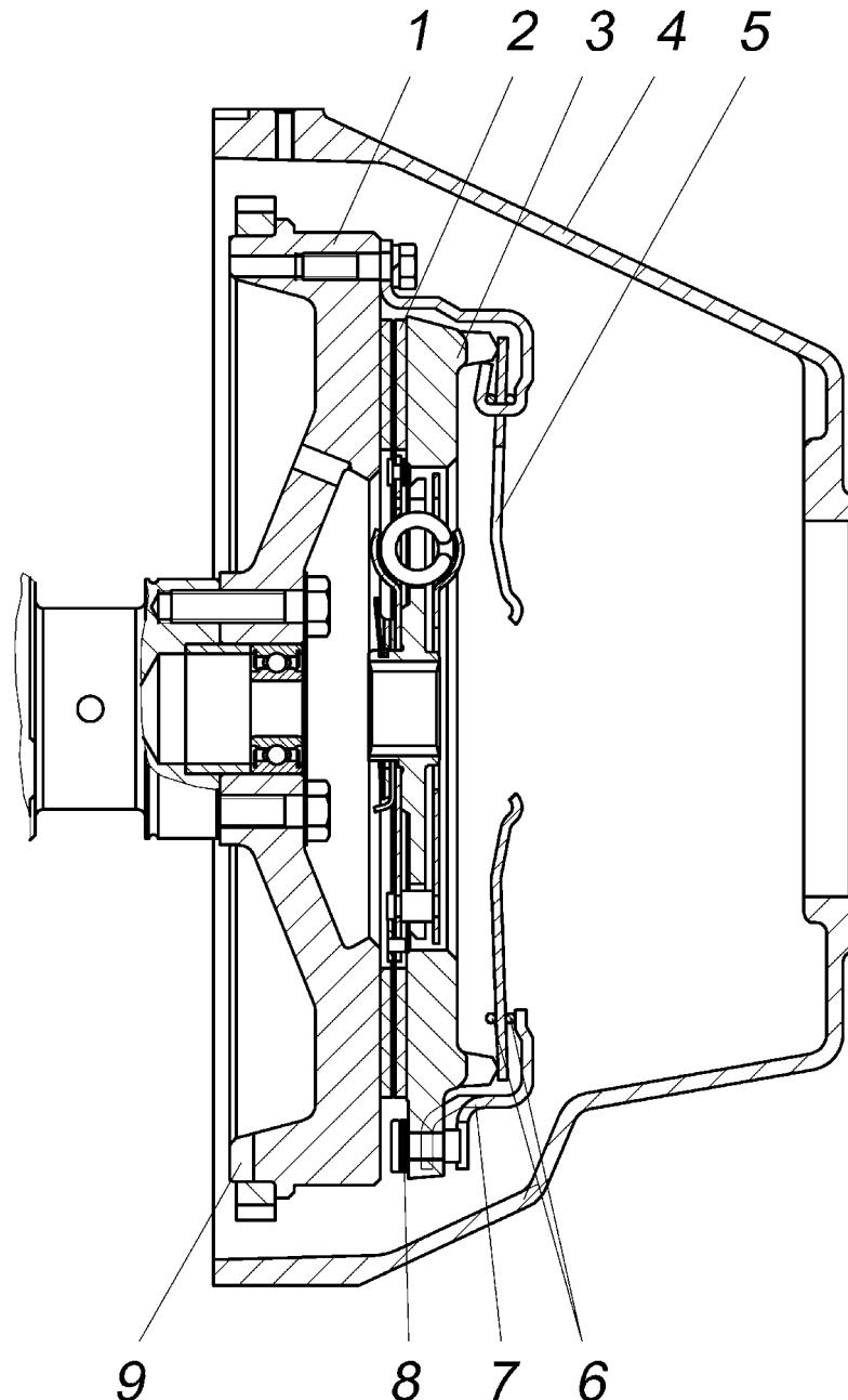
Рисунок 36 – Сцепление в сборе:
