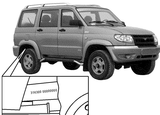
Рис. 1.3. Расположение идентификационного номера шасси
